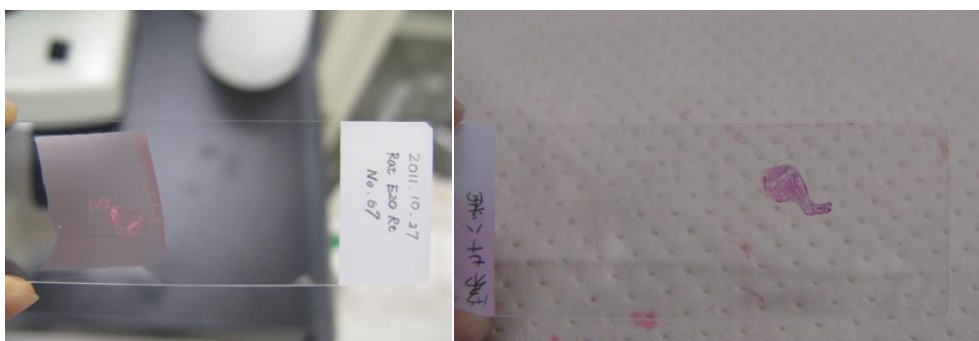
図 5. 薄切時に回収した切片に対して HE 染色を行ったもの。(左)回収切片を伸展後、スライドガラスに乗せた状態。(右)HE 染色が完了した組織標本。Wax は rehydration 系列のキシレンにより洗い流される。
